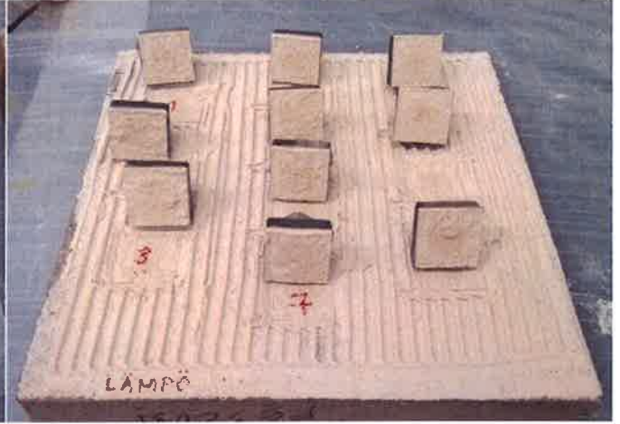
Kuva 2. Tartuntalujuus lämpörasituksen jälkeen.
