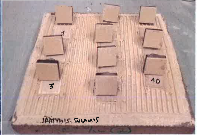
Kuva 4. Tartunta jäätymis-sulamisrasituksen jälkeen.
