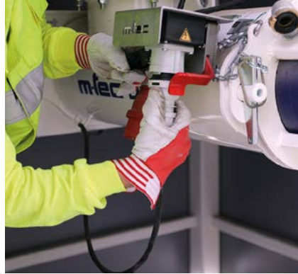
Liitä automaattisekoittimen moottorin virtakaapeli ohjausyksikköön.
